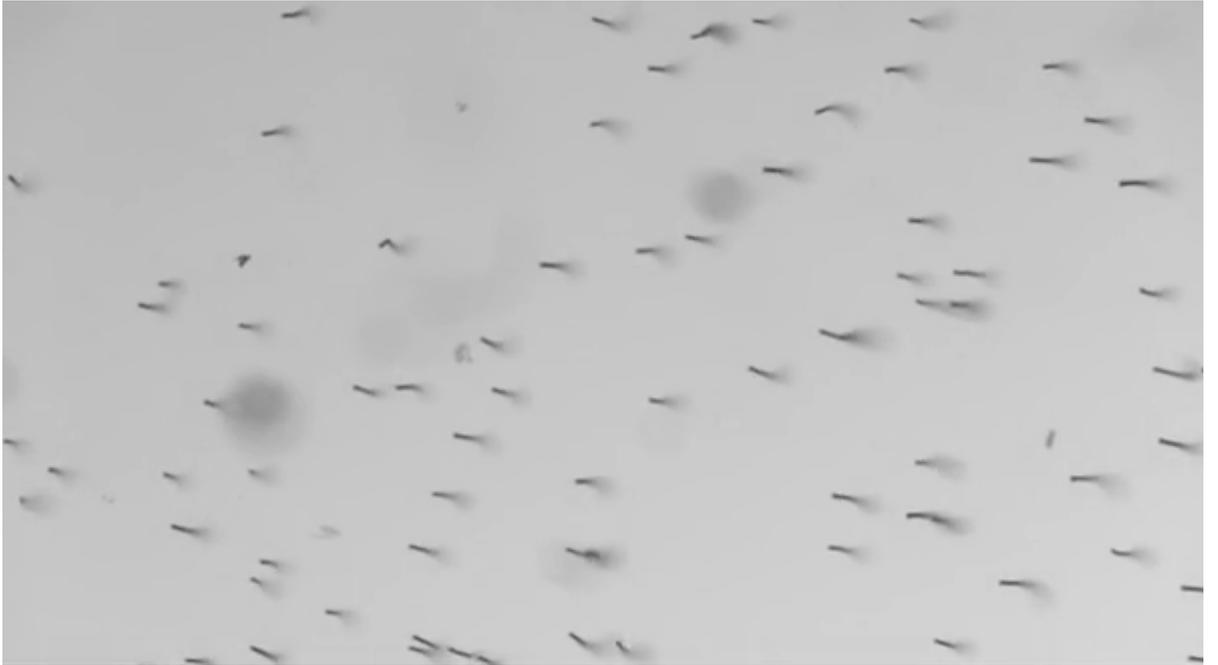
يظهر **هذا المقطع** ما يحدث عندما يتم تطبيق القوى المغناطيسية على الميكرو رودس المغناطيسية المزوجة بالمواد المكونة للقطب الكهربائي.
